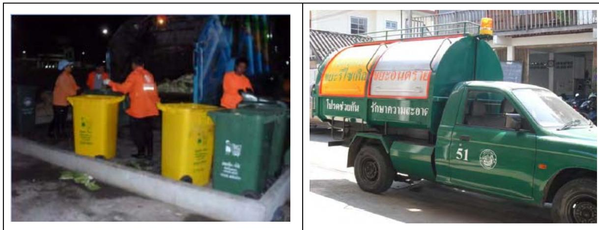
上の写真はチョンブリ市で利用されている回収トラックのものである。荷台がリサイクル用と有害廃棄物用に別れているものであるが、チョンブリ市の道路は狭いので、小型トラックを使用している。
